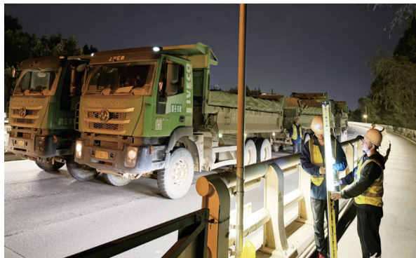
▲天圆大桥开展引桥荷载试验。
