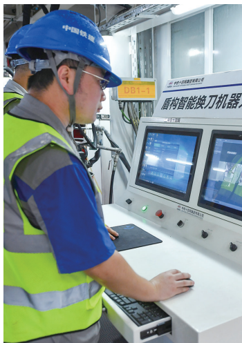
▲远程操控换刀机器人。
