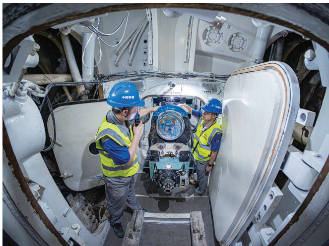
▲研发人员调试智能盾构换刀机器人。
